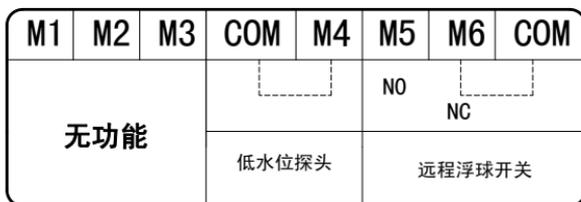
图 10 控制线端子（顺序可能与实际产品不同）
